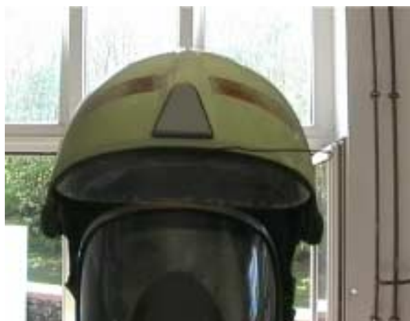
Bild 48: nach der Beflammung
