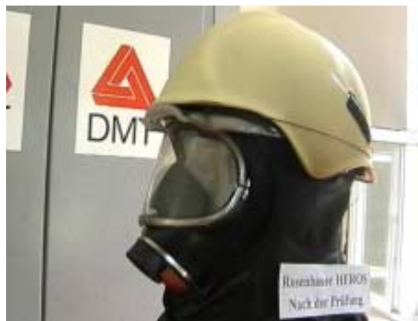
Bild 35 nach der Beflammung
