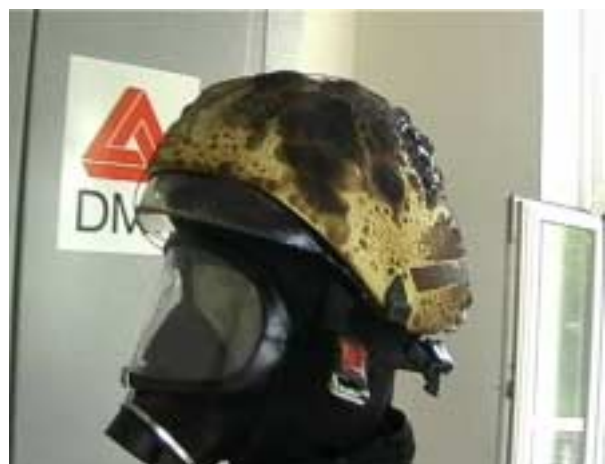
Bild 18: nach der Beflammung
