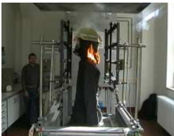
Bild 27: nach der Beflammung
