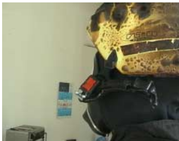
Bild 22: nach der Beflammung
