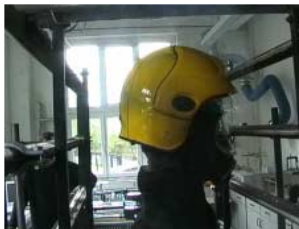
Bild 12: nach der Beflammung
