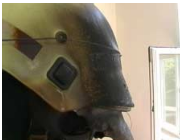
Bild 47: nach der Beflammung
